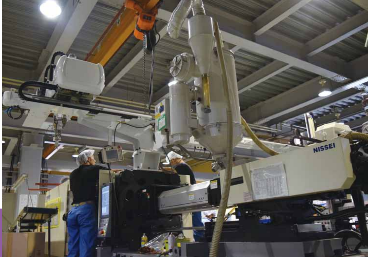
最先端のハイブリッド式射出成形機。検査の省人化に貢献している
