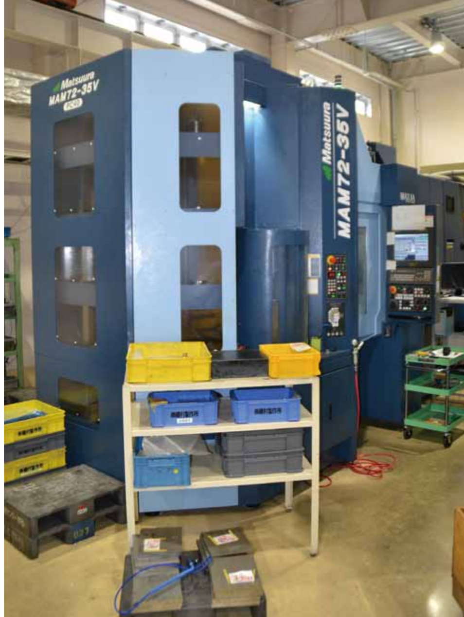
導入した5軸制御の立型マシニングセンター「MAM72-35V」。生産能力が大幅に向上した
