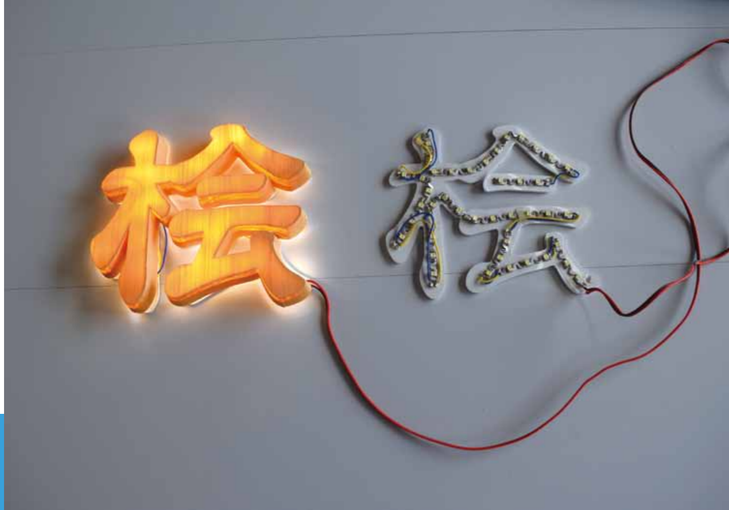
LEDを組み込んだアクリル上にヒノキの切り文字をかぶせて点灯すると木材が美しく光る
