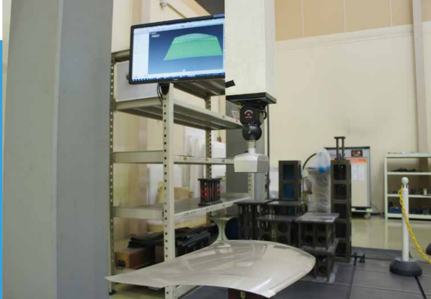
ものづくり補助金で非接触型の3次元測定スキャナを導入した
