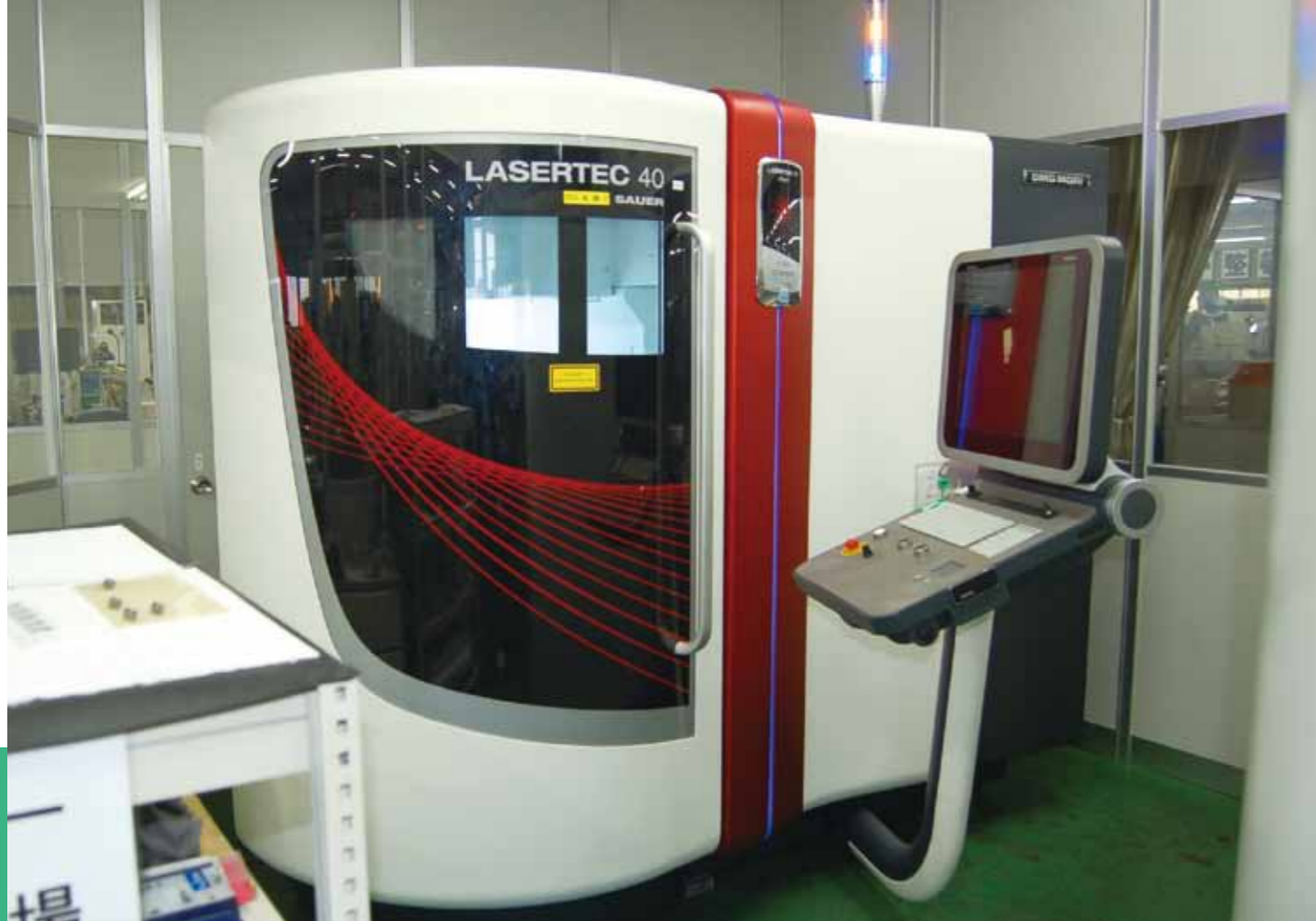
導入したレーザー加工機。出力やパルスなど加工条件を微細な単位で調整ができる
