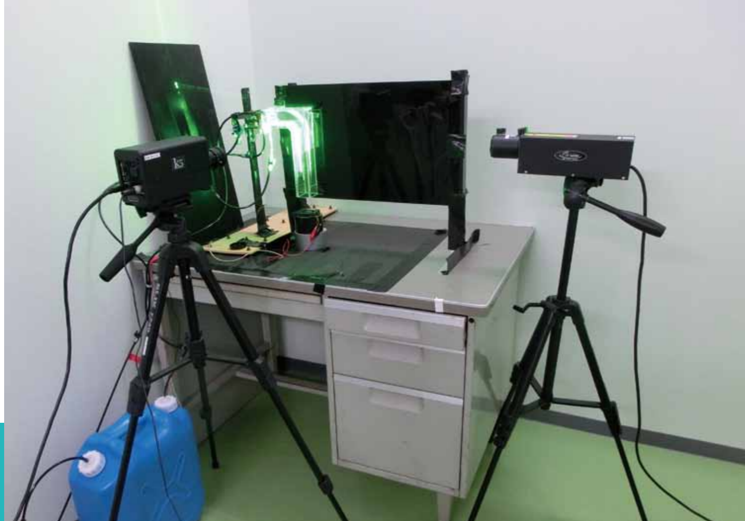
ものづくり補助金で導入したPIV装置。空気の流れを可視化することに取り組んだ
