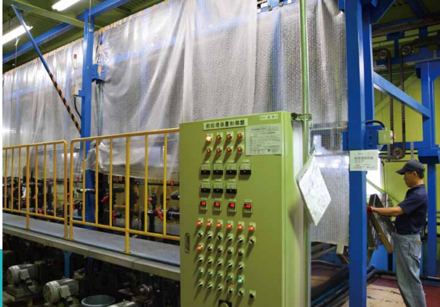
化成処理にジルコニウムを使った前処理工程設備。コストや環境面で効果を得た
