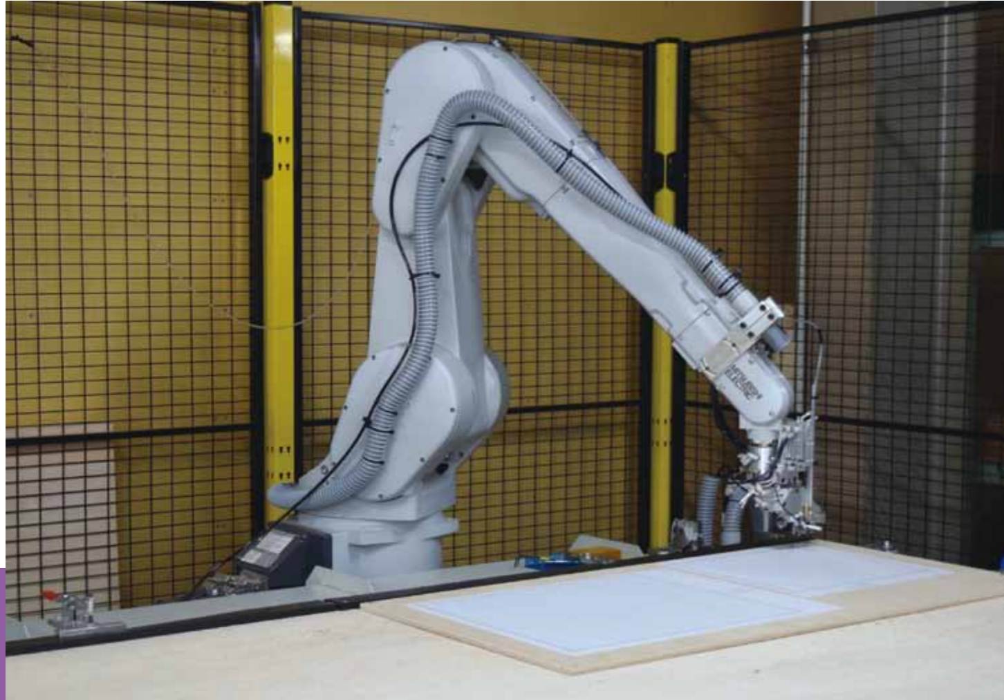
ものづくり補助金を利用して導入したロボット。ピン挿しの作業を担っている
