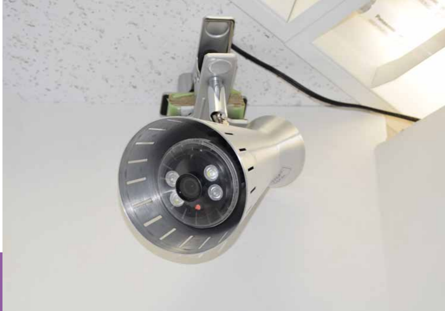
映像を離れた場所でもスマホなどで確認できる電球型Wi-Fiカメラ「DIAMOND」
