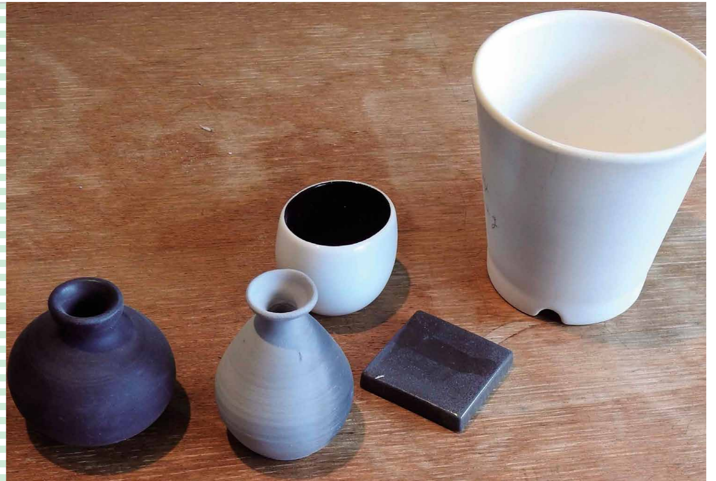
「3 minutes」の完成に向けて、試作を繰り返した。CNTを塗布しているのが特徴だ
