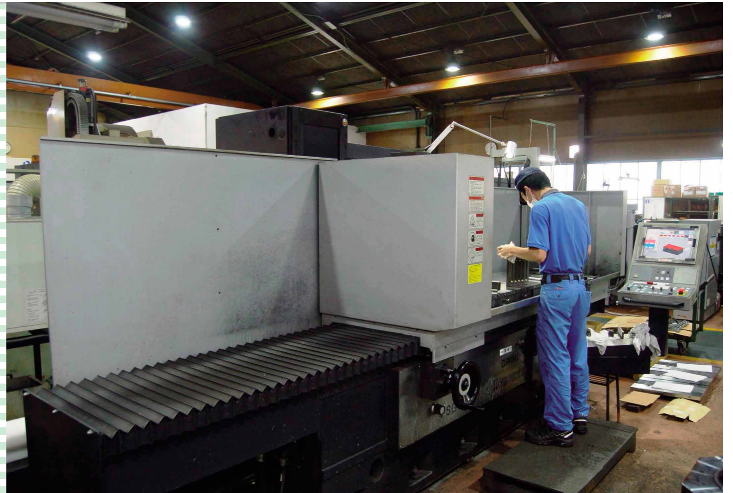
補助金で導入した平面研削盤。納期短縮に加え、外注工程の一部の内製化も図れた
