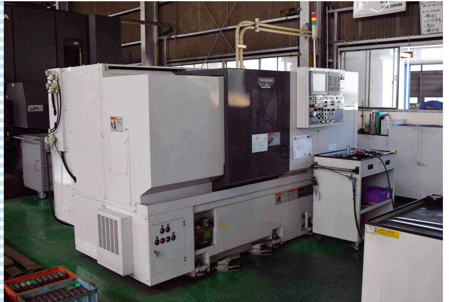
補助金で導入した複合CNC旋盤。小物部品の旋削、回転工具での切削工程を集約した
