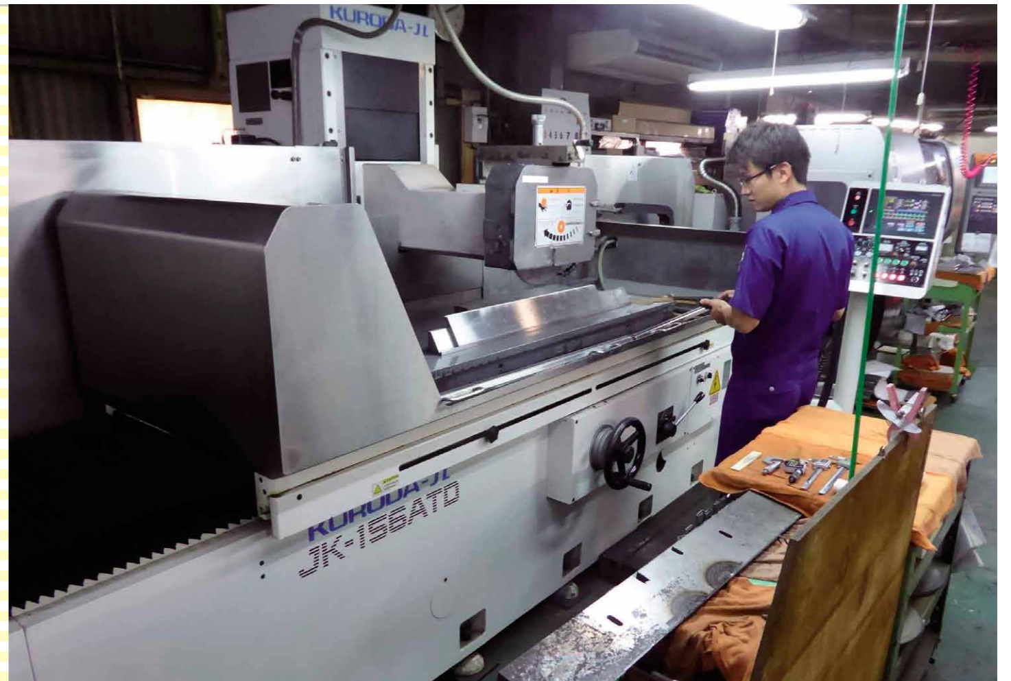
長尺のPCD製治具のために導入した平面研削盤。砥石の回転速度をインバーターで制御できる
