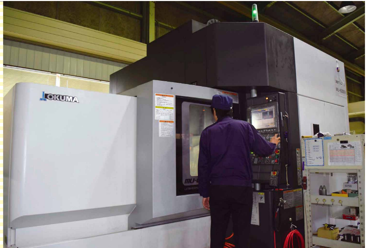
導入した5軸制御のマシニングセンター。新たな加工の可能性を広げている
