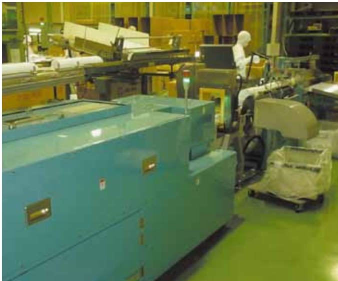
集積装置(写真奥)を両側排出として 将来的な自動包装機導入を視野に入れている
