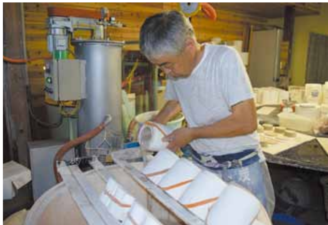
個性が生まれる流し込み排泥鑄込み製法
