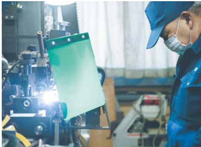
生産効率が向上した帯鋸の溶着機
