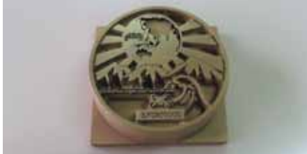
レーザー彫刻機で繊細な深彫り加工も実現
