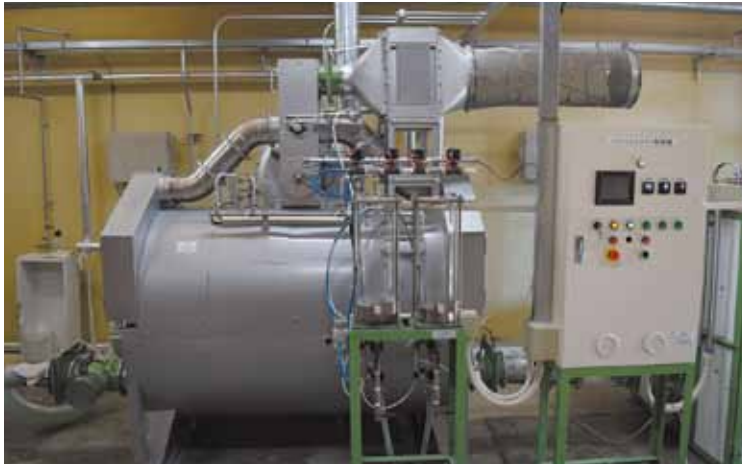
洗浄した羽毛を乾燥と同時に熱消毒する乾燥機
