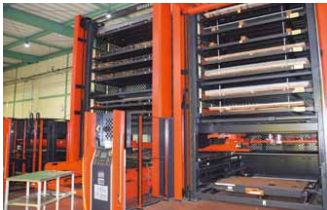
最大8種類の鋼板の在庫管理が可能な自動倉庫
