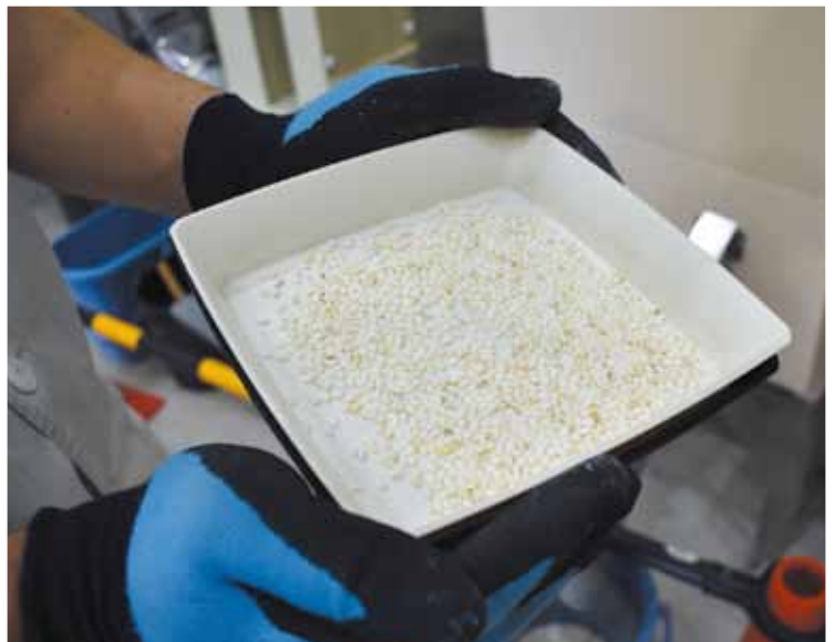
色選タンクで選別した米。米を取り出し、純度を確認する様子
