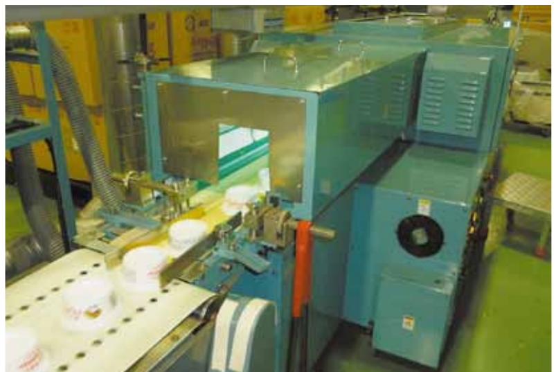
最大2倍の加工スピードに対応するUV乾燥機
