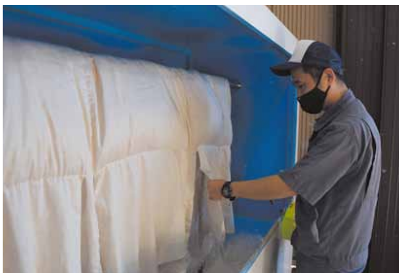
羽毛を残さず回収するため装置底部を改良
