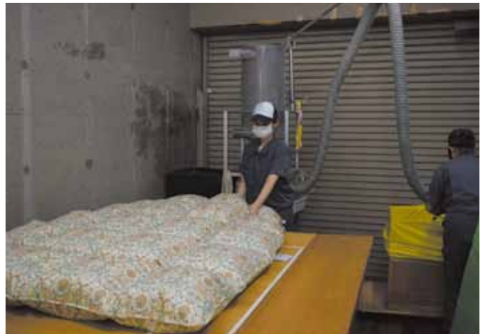
洗浄、乾燥した羽毛の吹き込み作業
