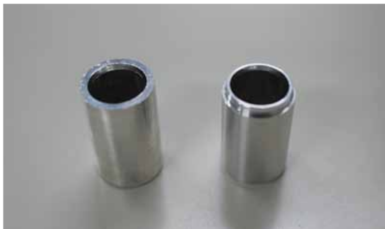
圧造品(左)に仕上げ加工を施し完成する(右)
