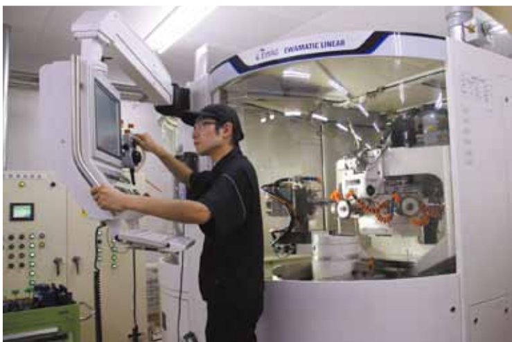
松岡俊佑オペレーターが操る機械内部で寸法測定できる工具研削盤
