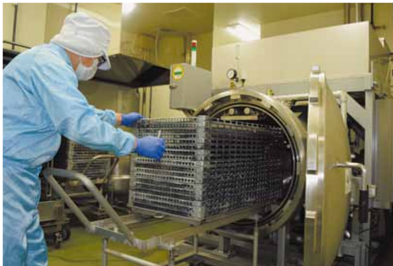
真空パックを加熱調理、殺菌するレトルト釜
