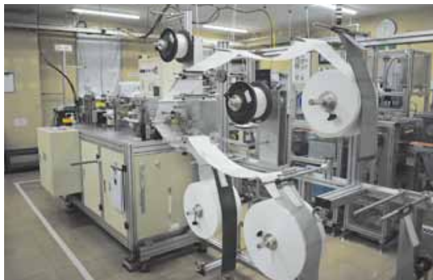
不織布マスクの国産化を実現したマスク製造機
