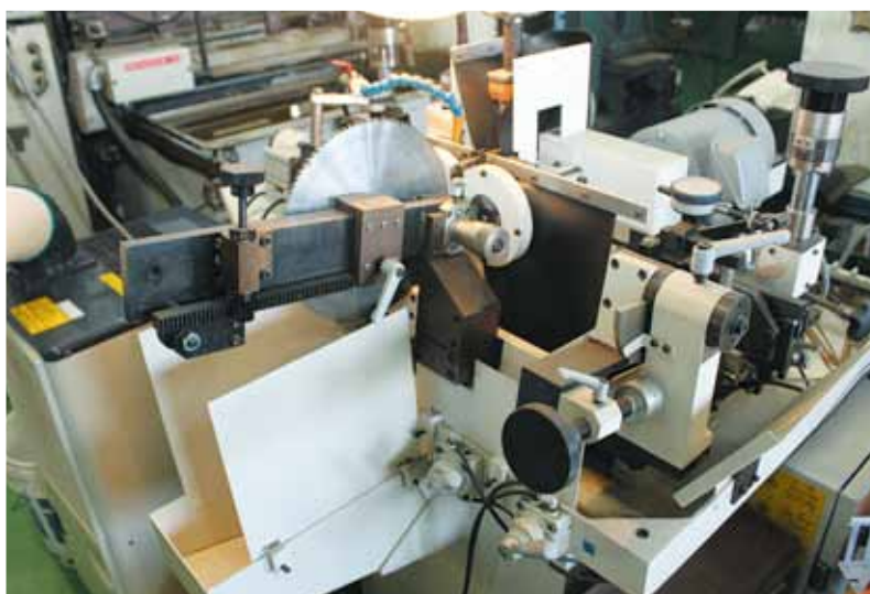
刃先の両側面を一度に研削する
