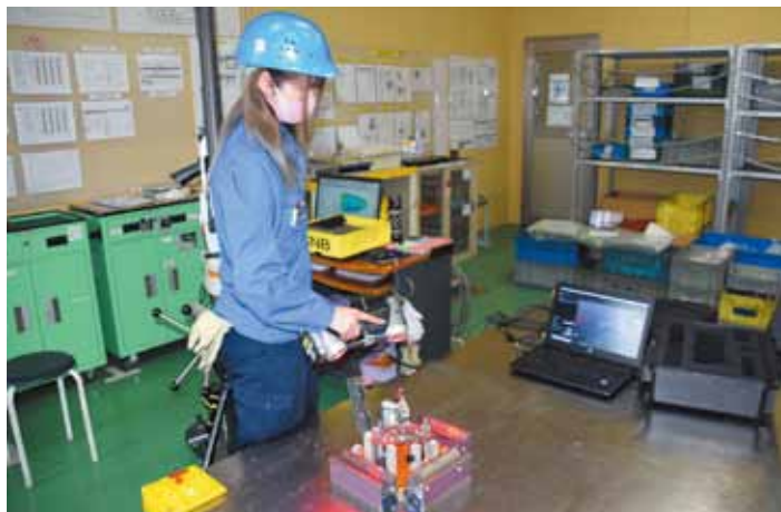
ハンディスキャナーは現場で金型などの測定ができ、工程の効率化につながった
