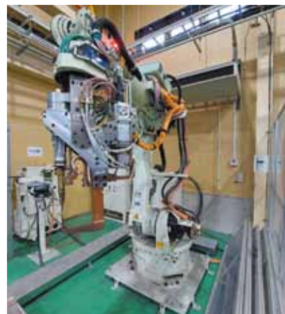
ロボットアームの配線を「見える化」し故障の予兆などに迅速に対応する
