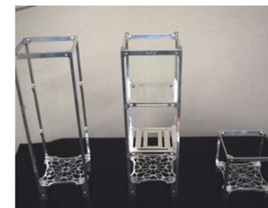
試作した超小型人工衛星の部品
