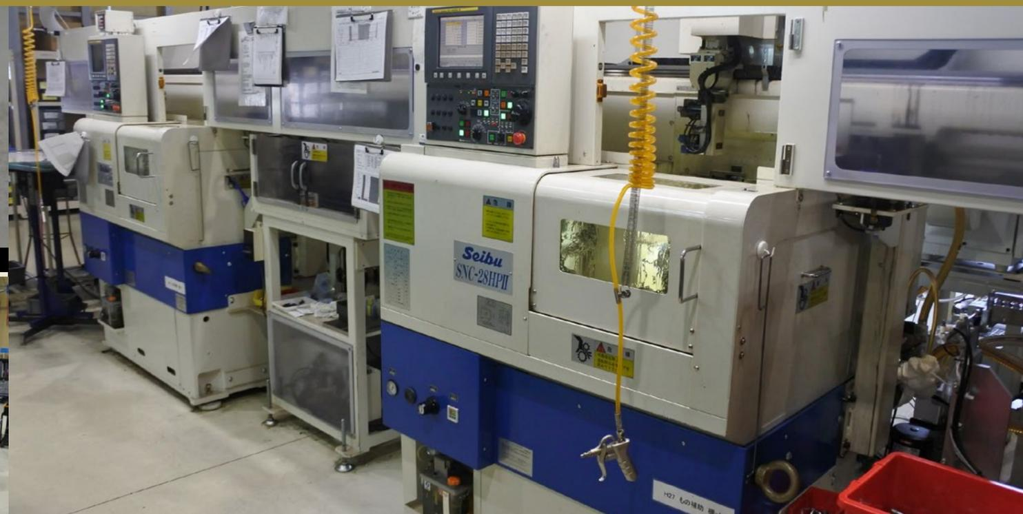
補助金で導入した西部電機の旋盤2台。ポペットの高精度旋削を実現した
