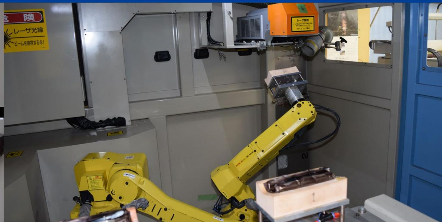
補助金を活用して六軸ロボットとレーザー加工機を組み合わせた機械設備を開発。無駄肉除去の機械化に取り組んだ
