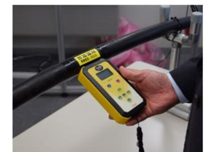
トヨタ自動車と共同開発した「高圧ケーブル遮蔽層断線検出器」
